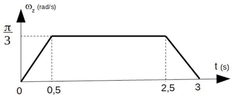
Vous êtes chargé de déterminer la loi de vitesse de l'actionneur (moteur) au point A satisfaisant à un angle d'ouverture de 90°.
