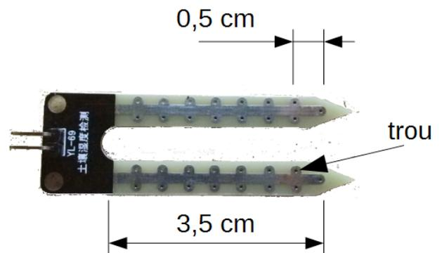
3. **Tracer** la caractéristique de transfert  $u_{AO} = f(\text{profondeur immergée des électrodes})$  et définir la zone de linéarité du capteur.
