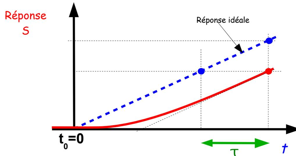
La mesure de l'erreur de traînage est **indépendante** des caractéristiques de la rampe appliquée pour un **système linéaire**
