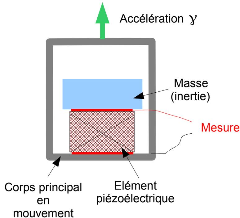
L'accéléromètre est constitué d'une masse  $m$  et d'un élément piézoélectrique qui fournit le signal électrique (variation de charges).
