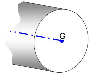
La contrainte n'est pas constante quel que soit l'endroit dans la section droite mais à notre niveau de résolution, nous ne tenons compte d'une contrainte **moyenne supposée constante**.
