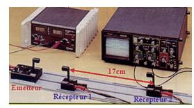
Dispositif expérimental : mesure de la vitesse des ultrasons dans l'air.
