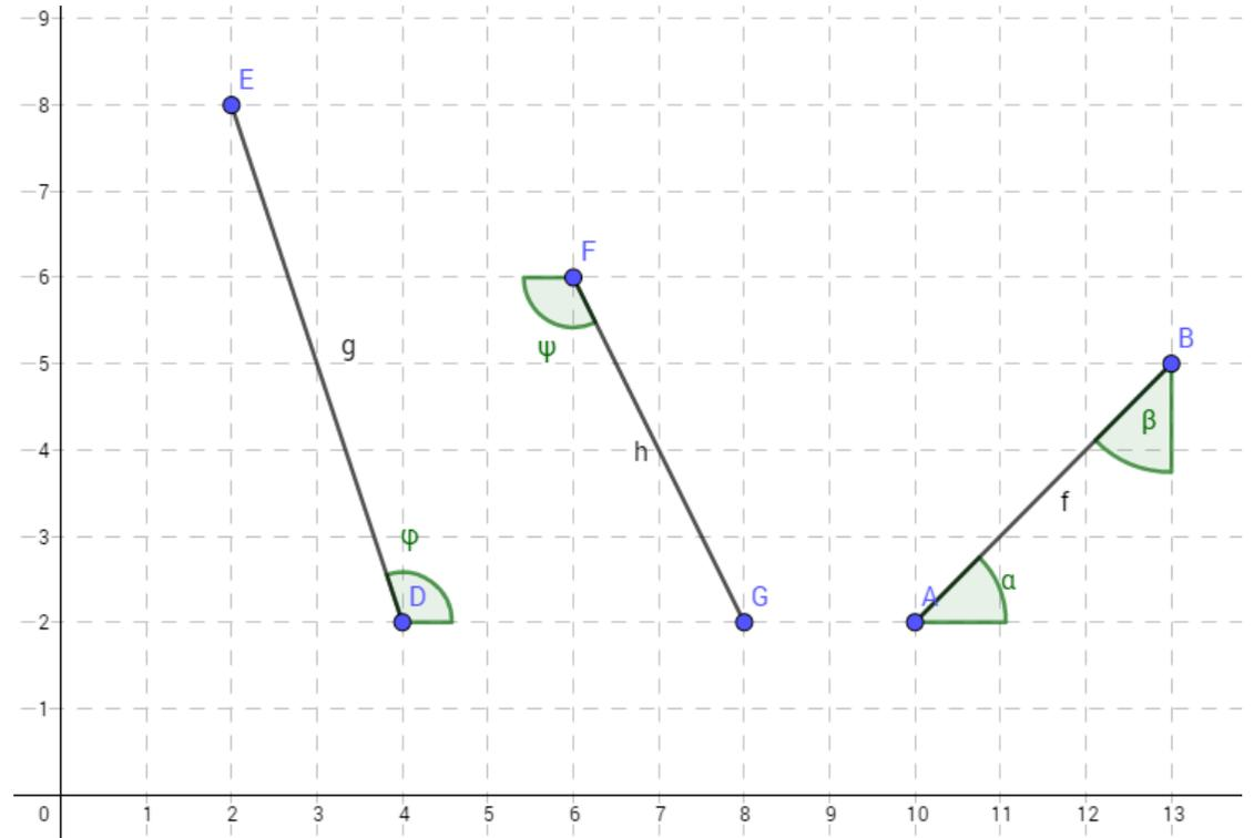
Déterminer les valeurs numériques des projections des vecteurs suivant sur les axes des ordonnées ainsi que des abscisses :
