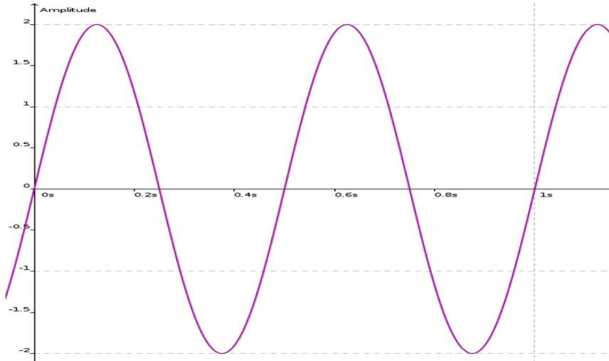
Dans de nombreux domaines, qu'il s'agisse de mécanique, d'acoustique ou d'électricité nous nous trouverons en présence de signaux tel que celui présenté ci-contre. Il s'agit d'un signal de type sinusoïdal.
