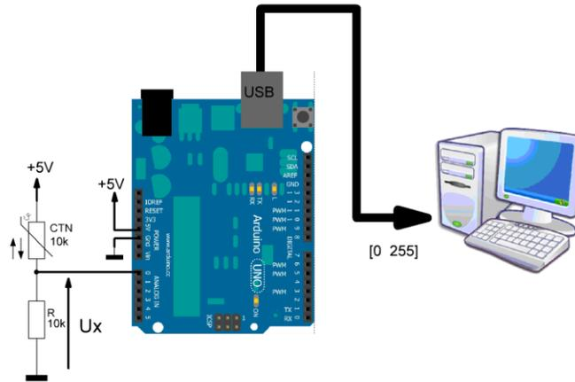
Fig. 6 : configuration de la chaine d'acquisition
