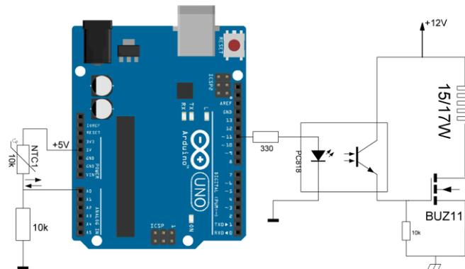
Fig. 8 : schéma électronique de la maquette
