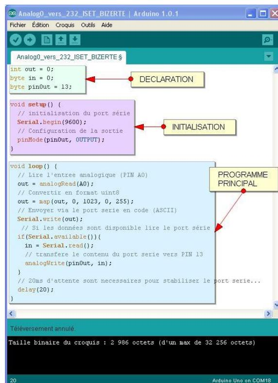
Fig. 1 : EDI Arduino et structure du programme
