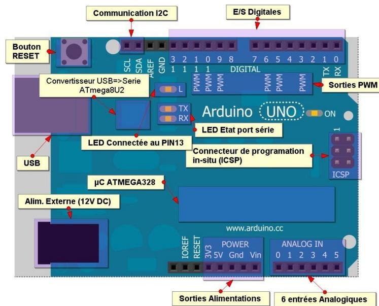
Fig. 2 : synoptique d'une carte Arduino Uno
