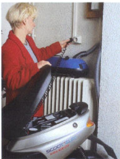
Muni d'un chargeur embarqué et d'un cordon de charge placé sous la selle, *Scoot'élec* se branche sur une prise domestique 230 V - 16 A / 2 P + PE.
