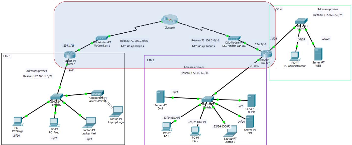
Pour réaliser l'interconnexion de vos LAN via le WAN, téléchargez le fichier Cisco Packet Tracer [suivant](#) et copier-coller la structure dans votre fichier Cisco Packet Tracer où vous avez déjà paramétré les LAN 1 à 3.
