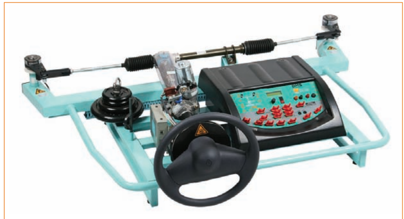
6 La maquette didactisée de la direction assistée électrique de la Twingo
